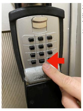
3. 押し間違えた時は、 下の段の真ん中のリセット ボタンを引き、最初から押 し直します。
