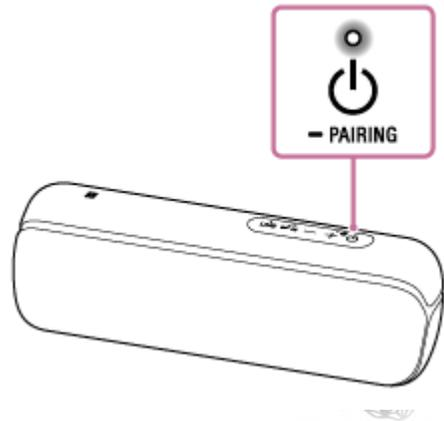
スピーカーから音声ガイダンスが流れ、BLUETOOTHランプが速く点滅を開始します
